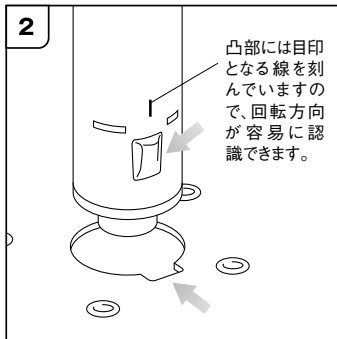
2 四隅にある脚固定用穴に脚パイプの凸部を合わせて差込みます。(その時、脚パイプ先端のボスが反対側に突き出たことを確認してください。)
